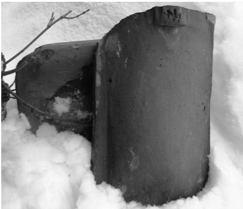
Gammel takstein fra Nes teglverk, merket med en "N". Industriprodukt fra Maridalen av topp kvalitet. Minst 130 år og fortsatt i bruk. Foto: db
